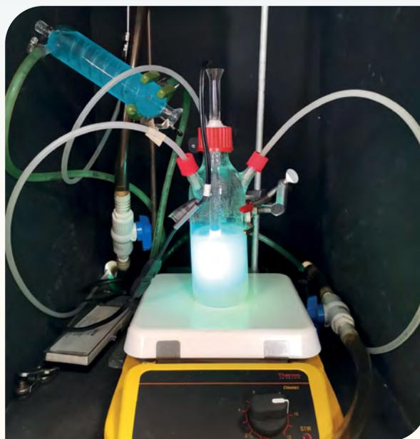
Reactor fotocatalítico a escala de laboratorio.
