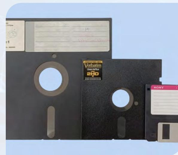
Figura 3. Discos flexibles de diferente capacidad de almacenamiento magnético.
